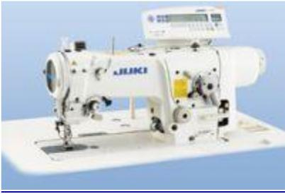
**Јuki LZ-2287 А Швейная машина типа зигзаг с фрикционным приводом**
