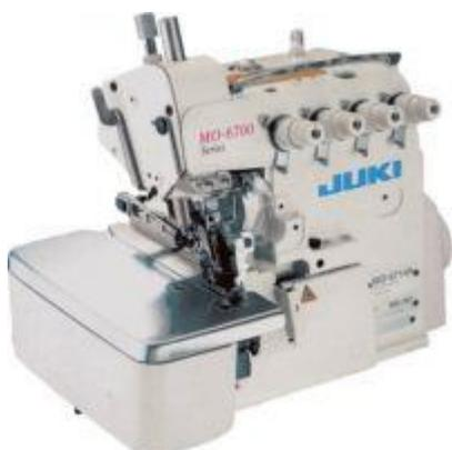
**Juki MO-6716 S DE6-40H 5-ниточный оверлок "неутопленный" стол с фрикционным приводом**
