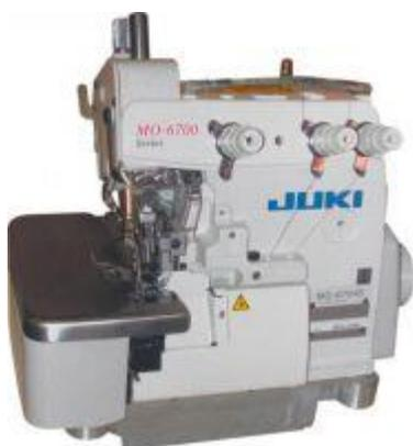
**Juki MO-6704 S OF6-50H (4.8 мм.) 3-ниточный оверлок с фрикционным приводом**
