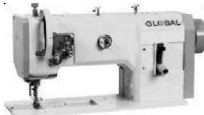
**Global WF-975 LH 1-игольная машина с цилиндрической платформой унисонным продвижением материала.**
